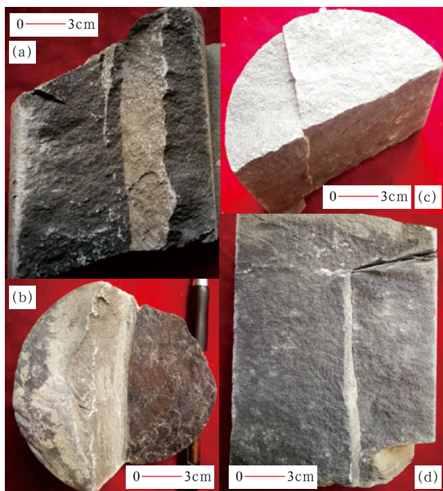
图4 钻井取心观察到的天然裂缝
