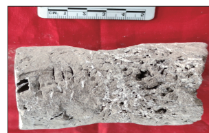
(d) HY-30井, 2407.8m, 马四段, 膏云岩, 溶孔发育
